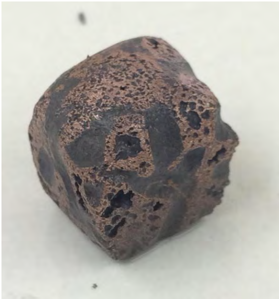
Figura 7. Imagem ampliada 4x - experimento 19 peça de cobre porosa
