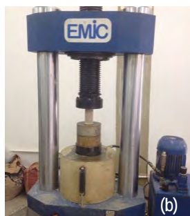
Figura 4. Rompimento dos corpos-de-prova Legenda: (a) CPs capeados; (b) Prensa; (c) CP após rompimento.
