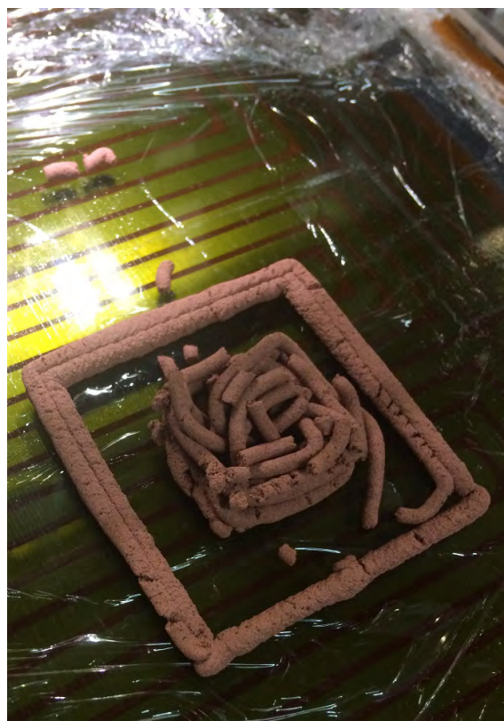
Figura 6. Impressa com alta tensão de cisalhamento
